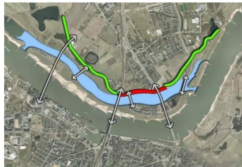
图三、实施后: 防洪堤被夷为平地, 一条新的河道促使更多的河水通过, 降低了洪水风险。并且一个岛屿在河流中间形成, 创造了新的发展空间, 新的桥梁将河流两岸的居民联系起来。
